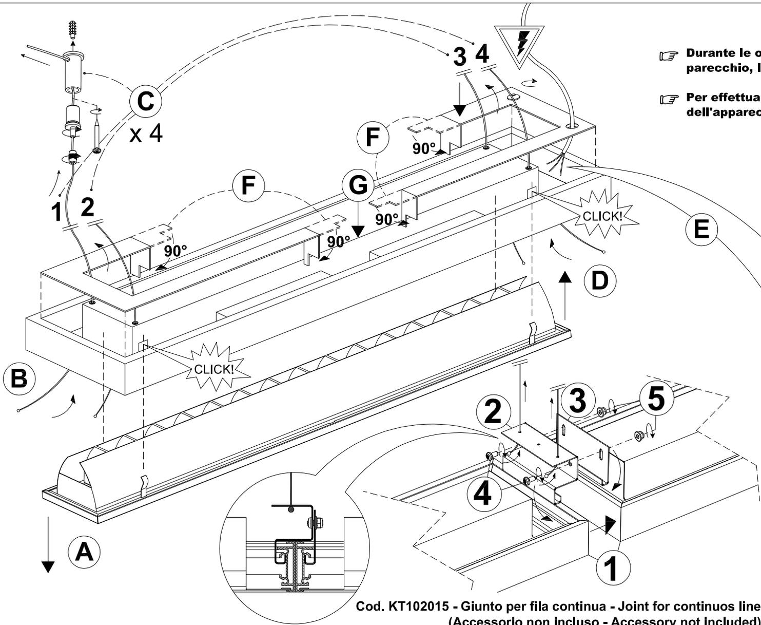
Cod. KT102015 - Giunto per fila continua - Joint for continuous line
