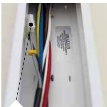
Particolare spinotto selezione di fase. Detail of the selection phase pin.
